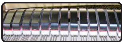
(C) "DAMPER"-Pedal ist losgelassen, Filzdämpfer liegen auf den Saiten auf.
